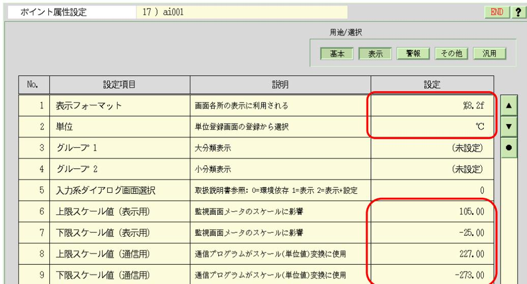
図 7.3.2 AI ポイント(室内温度)の属性設定
