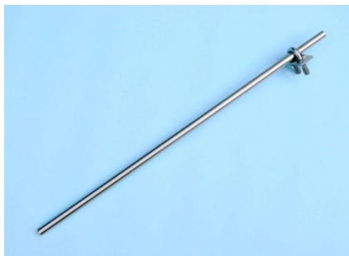
写真 7.2.3 温度センサ保護管
