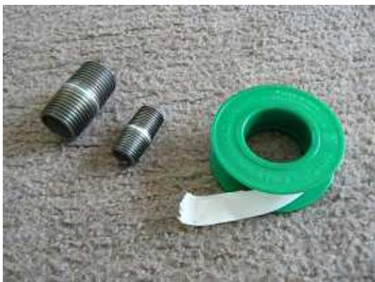
写真 8.2.10 配管部品(白ニップルとパイプシール)
