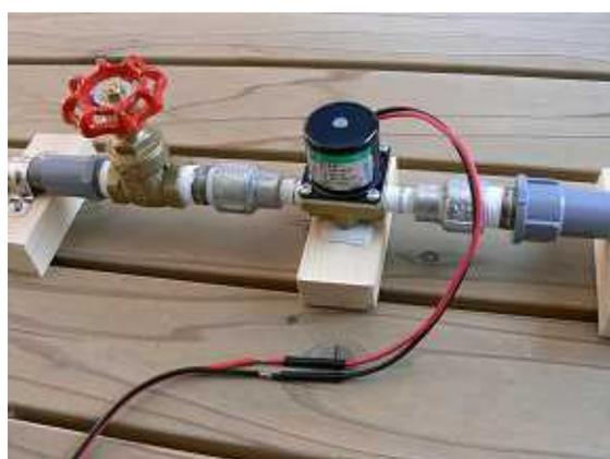
写真 8.2.13 電磁バルブの配線
