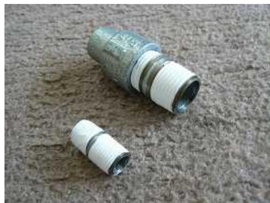
写真 8.2.11 パイプシールを使用して配管
