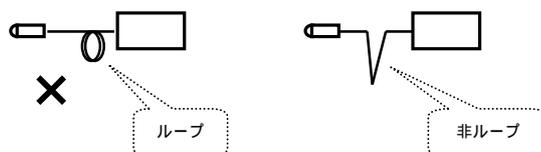
図 8.2.3 照度センサケーブルのループ配線の禁止
