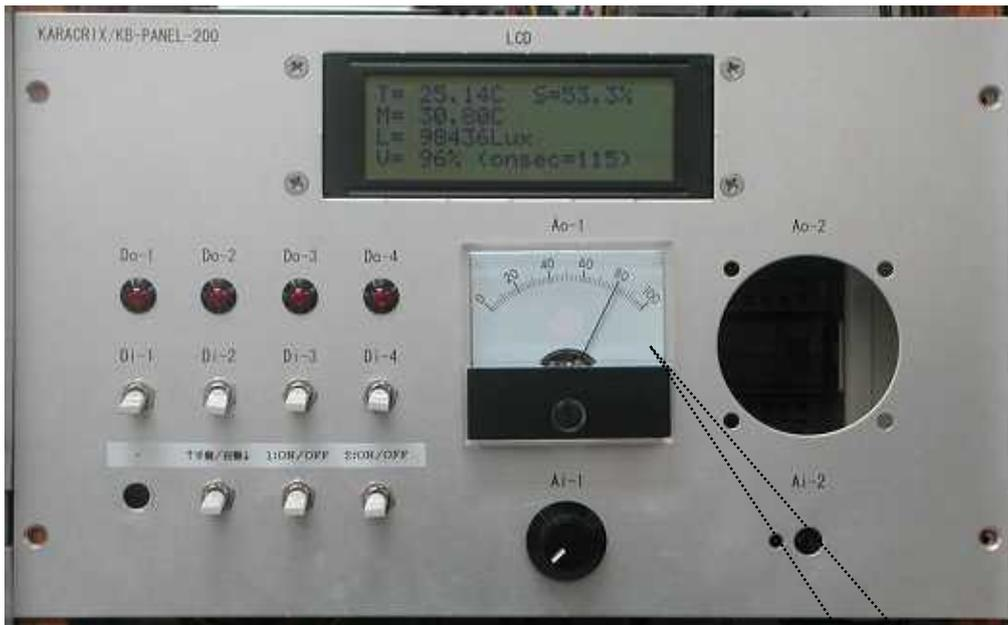
写真 8.8.5.2 簡易制御ボックスのコントロールパネル
